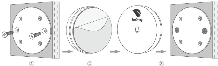
① Fixer le support sur votre mur avec les vis fournies. ② Un scotch double face 3M est déjà présent sur le bouton, retirer simplement la protection. ③ Coller le bouton sur le support.
